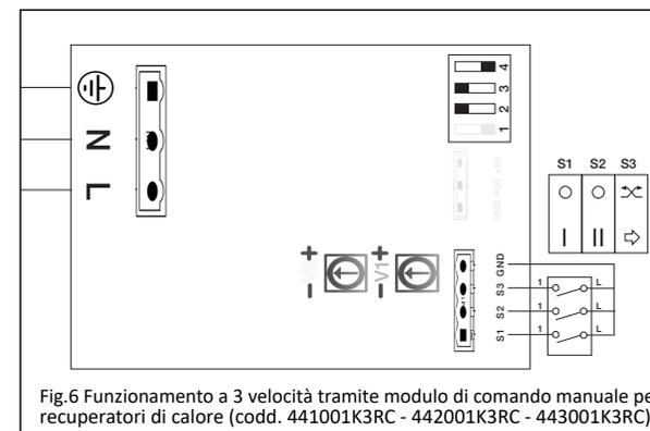
Fig.6 Funzionamento a 3 velocità tramite modulo di comando manuale per recuperatori di calore (codd. 441001K3RC - 442001K3RC - 443001K3RC)
