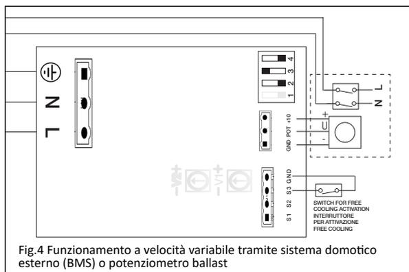
Fig.4 Funzionamento a velocità variabile tramite sistema domotico esterno (BMS) o potenziometro ballast
