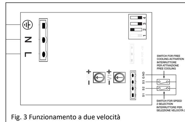
Fig.3 Funzionamento a due velocità
