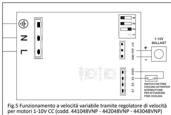
Fig.5 Funzionamento a velocità variabile tramite regolatore di velocità per motori 1-10V CC (codd. 441048VNP - 442048VNP - 443048VNP)
