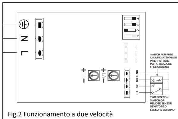
Fig.2 Funzionamento a due velocità
