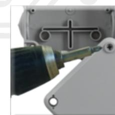
Serraggio con avvitatore pari ad 1/4 della coppia massima
