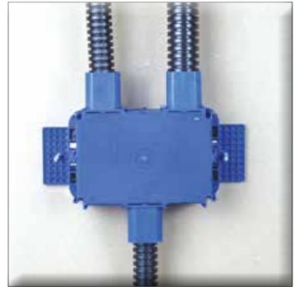
Staffa da utilizzare per il fissaggio della scatola all'interno della lastra, consentendo di installare la scatola da entrambi i lati della lastra contemporaneamente. La staffa è predisposta di fori per l'inserimento delle viti e di alleggerimenti (A - B) per facilitare la piega per l'applicazione alla lastra secondo la profondità del profilo metallico
