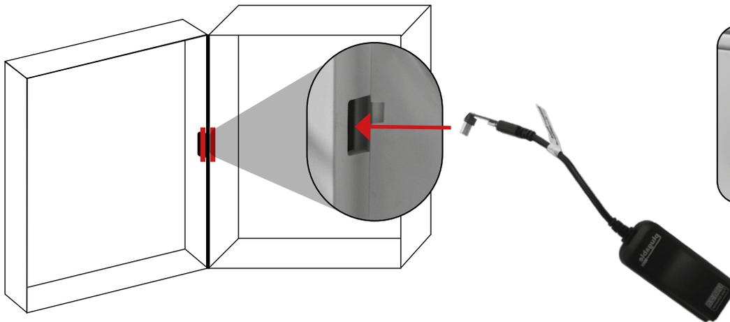
**Fig. 3 - fissaggio all'interno della centrale fixing inside the control unit**
