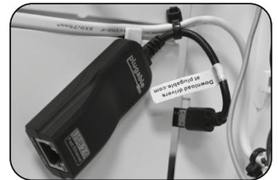
**Fig. 4 - aggancio alla porta USB / attaching the USB port**
