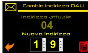
**Attenzione:** la funzione di cambio indirizzo è possibile solo con dispositivi 53AB-LIGHT con firmware REV.07 o successive. Non è possibile assegnare un indirizzo già in uso da un altro driver DALI.
