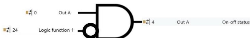
Qui sopra è possibile vedere un chiaro esempio di funzione di blocco. È una funzione ottenuta invertendo l'ingresso logico variabile, modificando l'opzione **Valore variabile**.
