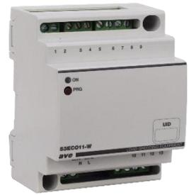
In base alla programmazione dei parametri, il dispositivo è in grado di ottimizzare l'energia prodotta in eccesso dall'impianto fotovoltaico, chiudendo il relè a bordo del dispositivo.
