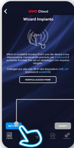
Mettiamo in modalità "access point" il cronotermostato premendo il pulsante per 2 secondi
