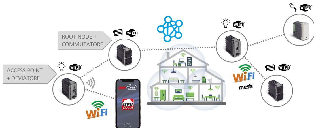
Modalità ROUTER DOMESTICO. Un dispositivo a scelta all’interno dell’impianto viene identificato come Root-Node. Connettendosi alla rete Wi-Fi® (generata dal router domestico) consente la supervisione, sia locale che remota, mediante l’applicazione AVE Cloud ed i più comuni Assistenti Vocali connessi al cloud.
