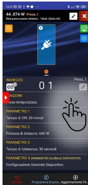
**Funzione:** Presa temporizzata. Possibilità di impostare: tempo di ON, potenza di distacco e tempo di tolleranza.
