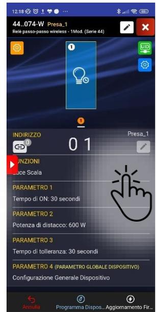
**Funzione:** Relè luce scale. Possibilità di impostare: tempo di ON, potenza di distacco e tempo di tolleranza.
