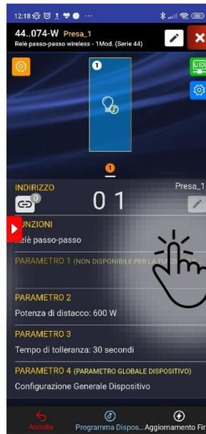
**Funzione:** Relè Passo Passo. Possibilità di impostare: potenza di distacco e tempo di tolleranza.
