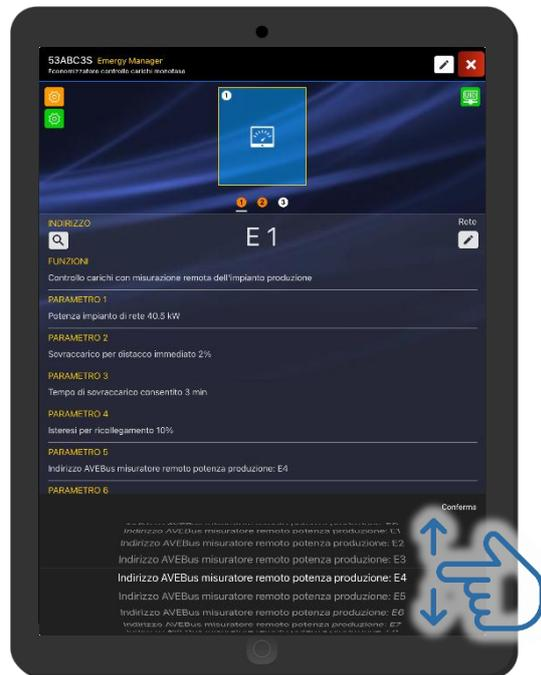
Il parametro si abilita solo se viene selezionata la funzione “controllo carichi con misurazione remota dell’impianto di produzione (autoconsumo)”. Esso definisce l’indirizzo del misuratore (53ABM3S) che invia il dato di potenza al controllo carichi.
