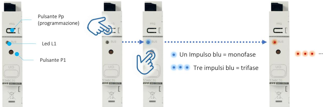
Il LED L1 lampeggia poi velocemente di colore ROSSO per indicare che il dispositivo è nello stato di programmazione. Lo stato è riconoscibile attraverso il LED L1 che inizia a lampeggiare velocemente con colore Rosso.
