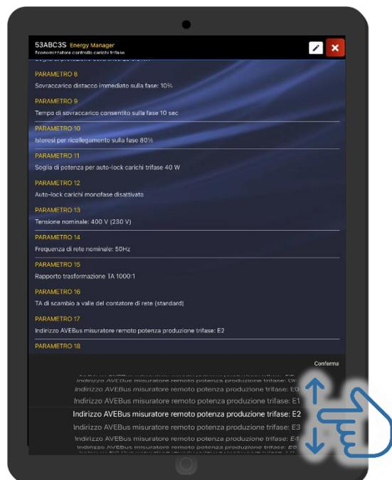
Se l'impianto prevede l'autoproduzione di energia trifase, la misura della potenza viene fatta remotamente dal misuratore 53ABM3S e viene riconosciuta dal controllo carichi assegnando l'indirizzo dal quale proviene il dato.
