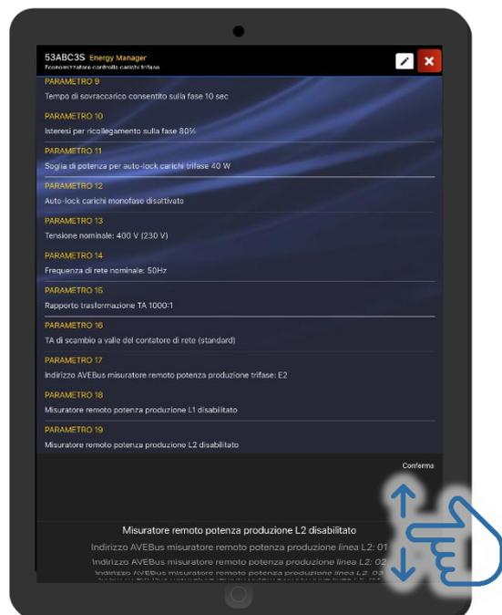
Se l'impianto prevede l'autoproduzione di energia monofase, la misura della potenza viene fatta remotamente dai misuratori 53ABM3S e viene riconosciuta dal controllo carichi assegnando l'indirizzo dal quale proviene il dato.
