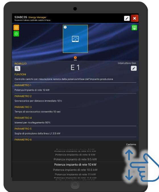
Il parametro 1 definisce il valore della potenza fornita dal gestore della rete di distribuzione elettrica (valori impostabili da 1 KW fino a 100 KW)
