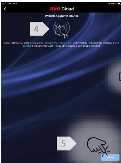
Mettiamo in modalità programmazione il dispositivo "Access Point" premendo per 8 secondi fino al doppio lampeggio del
