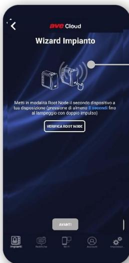
Mettiamo il secondo termostato in modalità root node. Premiamo il pulsante in alto a sinistra per 8 secondi.
