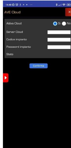
E' possibile inserire l'indirizzo, il codice e la password per connettere l'impianto al Cloud
