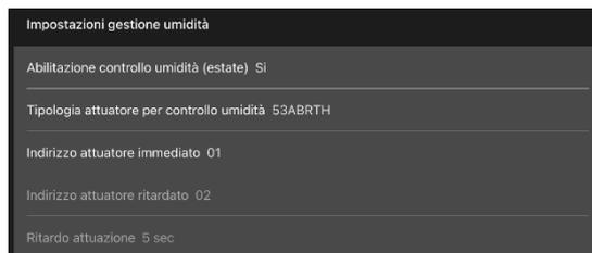
Oppure Attuatore **GENERICO**. In questo secondo caso abbiamo la possibilità di utilizzare dei relè connessi per gestire il comando della deumidificazione (per esempio il 44x074-W oppure 53ECOR16A-W). Se scegliamo questa opzione vengono abilitati tutti i parametri. Possiamo quindi inserire due indirizzi distinti. Uno che verrà comandato istantaneamente mentre l'altro a cui sarà possibile applicare un ritardo fino a 20 minuti.
