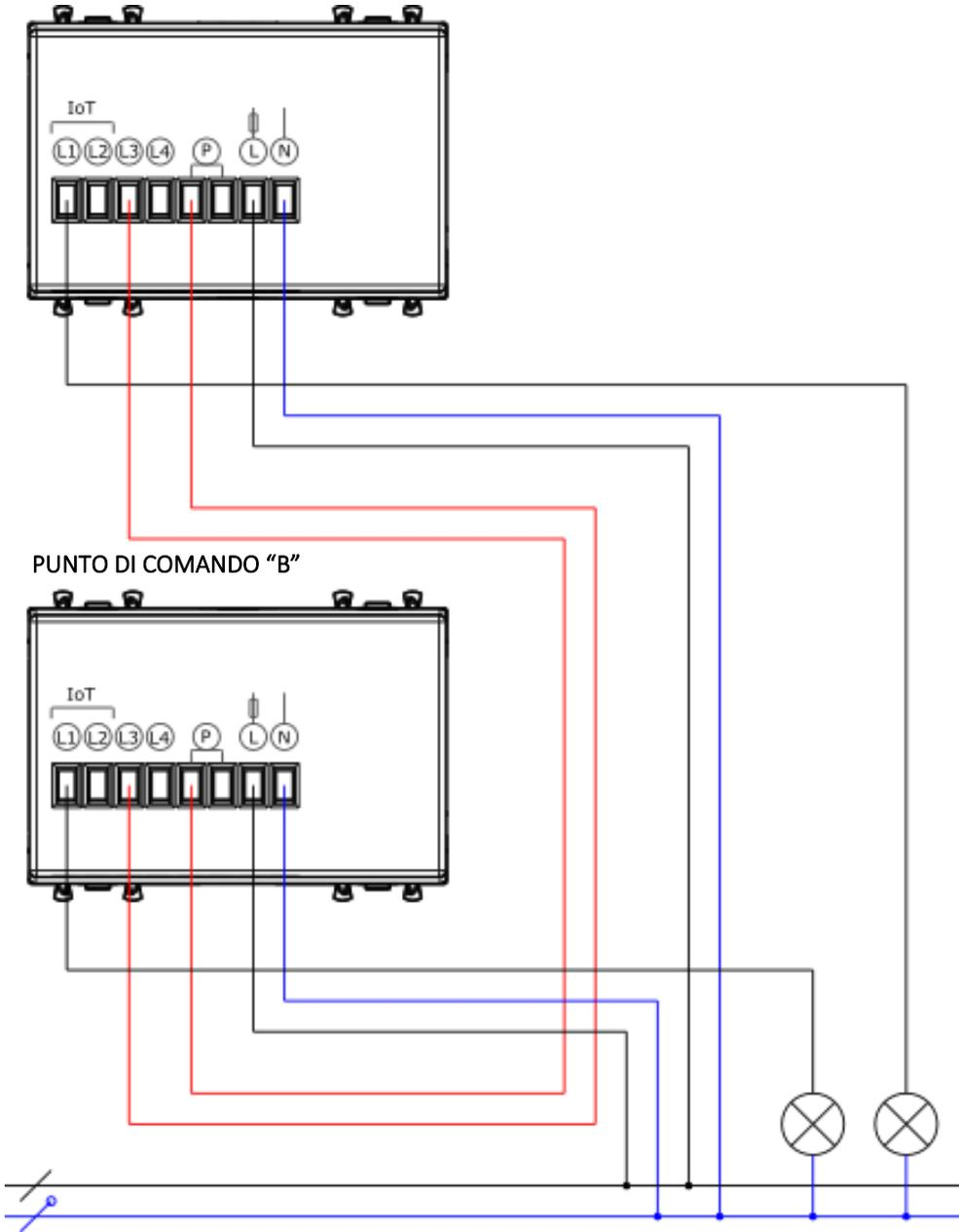
L'esempio mostra la possibilità di gestire i punti luce da entrambi i dispositivi di comando anche attraverso il collegamento filare. Si sfrutta l'uscita impulsiva del relè locale "L3" e l'ingresso "P" di entrambi i dispositivi.
