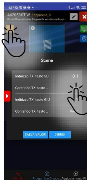
**Funzione:** Viene abilitata la possibilità di associare gli indirizzi avebus da comandare ed il tipo di comando da inviare (On, Toggle, Off, Up, Down)
