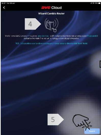
Mettiamo in modalità programmazione un dispositivo premendo per 8 secondi fino al doppio lampeggio del led. **E' necessario che non sia il nostro "Root Node"**.
