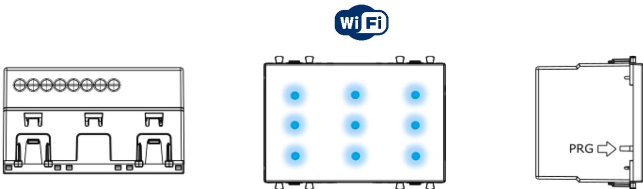
La vista inferiore mostra le viti per serraggio dei morsetti. La vista frontale mostra il posizionamento dei led. La vista laterale mostra la posizione del pulsante PRG per la programmazione del dispositivo
