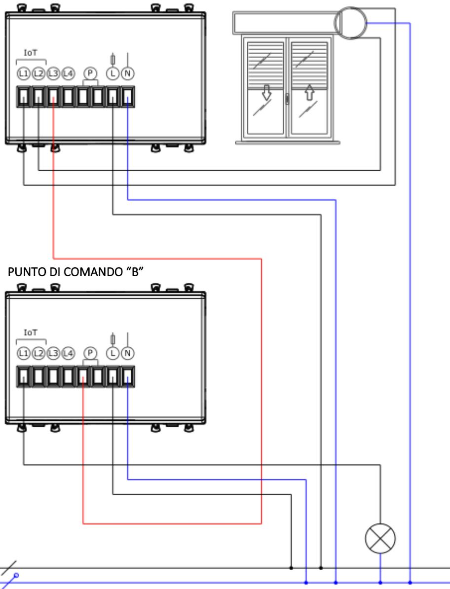
L'esempio mostra la possibilità di gestire la funzione tapparella dal punto di comando A. Sempre dal punto di comando A è possibile pilotare il punto luce collegato al punto di comando B attraverso il comando filare: uscita impulsiva del relè L3 ed ingresso P.
