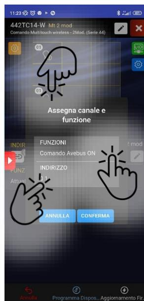
Selezione della funzione da associare al pulsante in basso a destra. Possibilità di eseguire un comando Avebus. Specificando se "ON", "OFF" oppure "TOGGLE". E' necessario indicare anche l'indirizzo.
