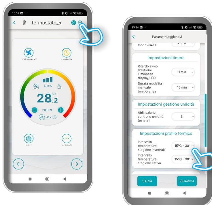
E' possibile modificare il profilo termico secondo intervalli. Gli intervalli impostabili per entrambe le stagioni vanno da: 5 °C / 20 °C fino a 20 °C / 35 °C
