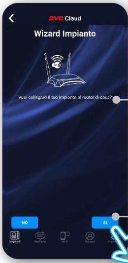
Possiamo scegliere se collegare o meno il nostro termostato al router di casa. Se premiamo "NO" utilizzeremo la rete locale generata dal termostato. L'applicazione ci darà la possibilità di personalizzare SSID e Password.
