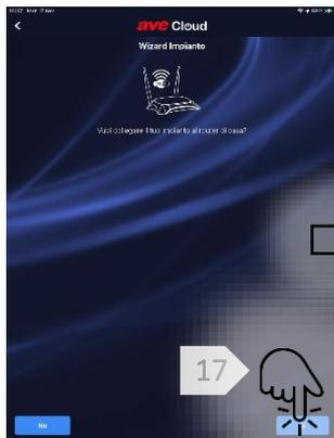
Possiamo a questo punto scegliere se collegare o meno il nostro impianto al router domestico. Scegliendo no l'impianto utilizza come Access-Point il dispositivo IoT configurato in precedenza.
