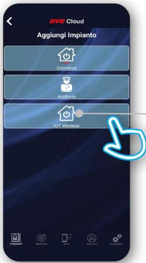
Visto che si tratta del termostato connesso selezioniamo un impianto "IoT Wireless". In questo modo si avvia la procedura guidata per la creazione degli impianti IoT.
