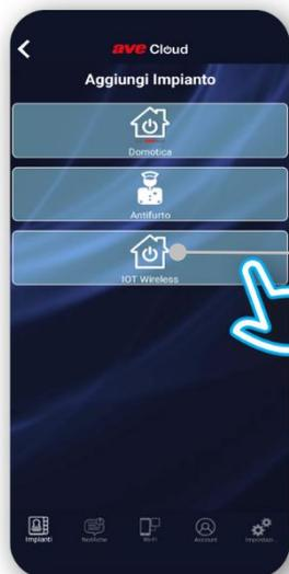
Visto che si tratta del termostato connesso selezioniamo un impianto “IoT Wireless”. In questo modo si avvia la procedura guidata per la creazione degli impianti IoT.
