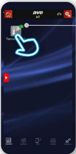
Impianto costituito da un unico dispositivo. Si tratta del nostro termostato dove la R indica che è il root node.
