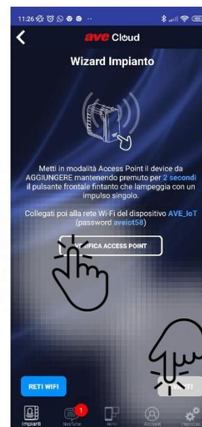
Viene avviata la procedura guidata per l'aggiunta di un nuovo dispositivo all'impianto
