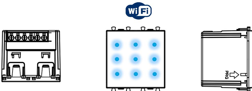
La vista inferiore mostra le viti per serraggio dei morsetti. La vista frontale mostra il posizionamento dei led. La vista laterale mostra la posizione del pulsante PRG per la programmazione del dispositivo
