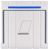
L'articolo 44XGA33N è un interruttore a badge universale con ritardo regolabile all'estrazione della carta. Il dispositivo è dotato di un relè monostabile ad 1 contatto in chiusura (16 A / 250 Vca) libero da potenziale ed ha dimensione di due moduli del Sistema 44. L'attivazione dei carichi può essere effettuata mediante schede magnetiche chip card o simili (del formato standard ISO 7816 o di altro formato) purché con spessore massimo pari a 1,5 mm.
