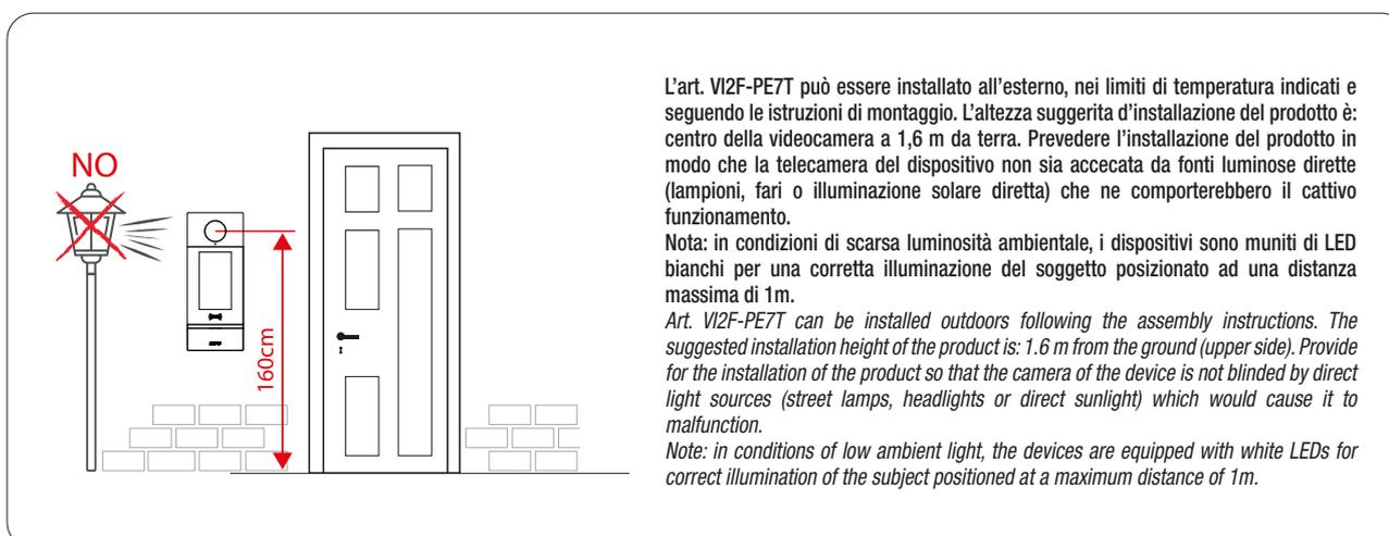
L'art. V12F-PE7T può essere installato all'esterno, nei limiti di temperatura indicati e seguendo le istruzioni di montaggio. L'altezza suggerita d'installazione del prodotto è: centro della videocamera a 1,6 m da terra. Prevedere l'installazione del prodotto in modo che la telecamera del dispositivo non sia accecata da fonti luminose dirette (lampioni, fari o illuminazione solare diretta) che ne comporterebbero il cattivo funzionamento.
