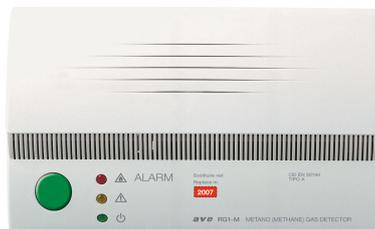
Rivelatore gas metano da parete. Alimentazione 230Vac. Uscita con contatto in scambio n.a. e n.c. Funzione di autodiagnosi attivabile da pulsante frontale. Dimensioni: 156 x 95 x 42 mm.
