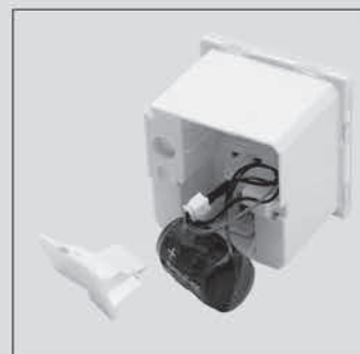
Sostituzione batteria Battery replacement
