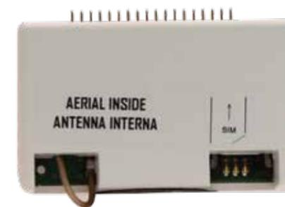
**Nota.** inserire i moduli GSM solo dopo aver scollegato l'alimentazione di rete 230Vac e le batterie
