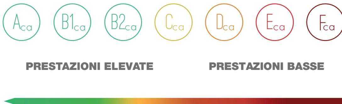
**Fig. 1 – Classi di reazione al fuoco def nite dalla Norma UNI EN 13501-6**
