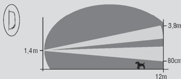
Nota: Prediligere installazioni dove ci sia un muro / pavimento a delimitare il campo di rilevazione del sensore. Se il sensore è puntato nel vuoto la distanza di copertura si riduce a 8 m. Dove non sia possibile una installazione parete/parete o soffitto/pavimento prediligere l'installazione a sensore inclinato.
