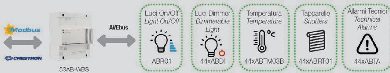
Il web server domotico 53AB-WBS permette di esporre il funzionamento dei dispositivi all'interno di registri Modbus, permettendone così il controllo e la gestione in modalità "slave" da un qualsiasi sistema BMS/SCADA compatibile con lo standard.
