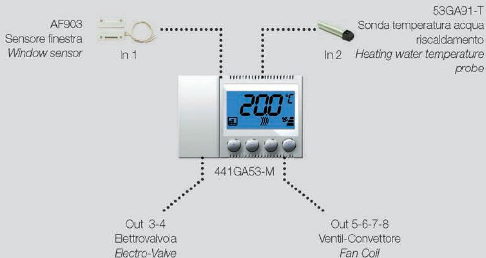
\* nota L'ingresso 2, per il riconoscimento automatico della stagione, è utilizzato solo in modalità stand-alone
