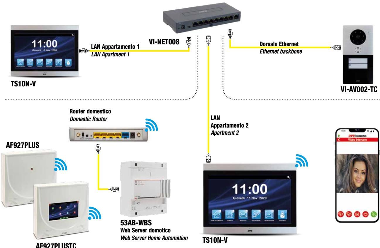
La gestione dell'impianto Domotico è subordinata alla presenza di almeno un dispositivo Web Server DOMINA, il cui webclient viene aperto ed utilizzato dalla postazione interna audio-video mediante una connessione Wi-Fi indipendente dalla rete Ethernet del Posto Esterno.
