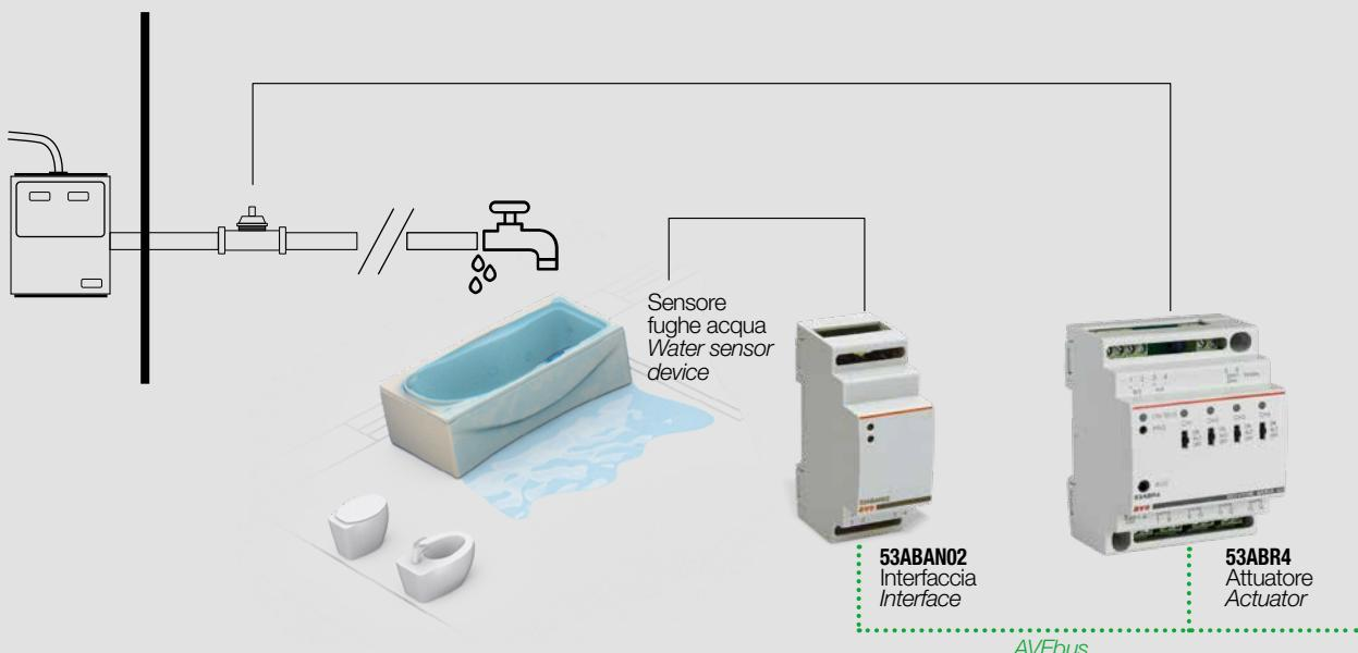
L'interfaccia analogica acquisisce il segnale dal sensore di fughe di acqua e, in funzione dei livelli di soglia programmati, invia su AVEBus se necessario, il comando di ON e/o di OFF per l'attuatore. Tutte le operazioni possono essere monitorate opzionalmente da un supervisore TS0x.
