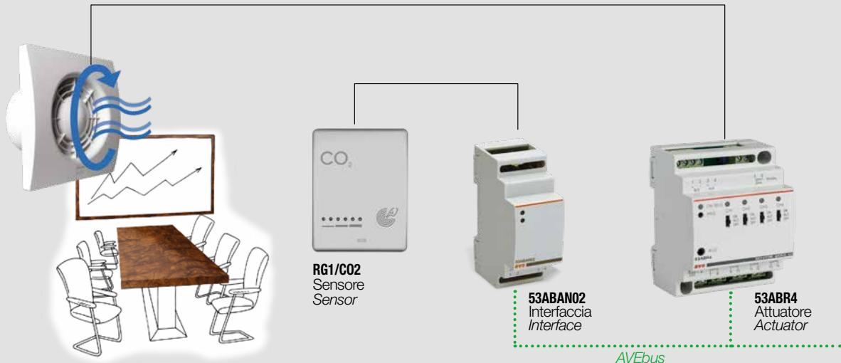
L'interfaccia analogica acquisisce il segnale dal sensore di qualita' dell'aria e, in funzione dei livelli di soglia programmati, invia su AVEBus se necessario, il comando di ON e/o di OFF per l'attuatore. Tutte le operazioni possono essere monitorate opzionalmente da un supervisore TS0x.
