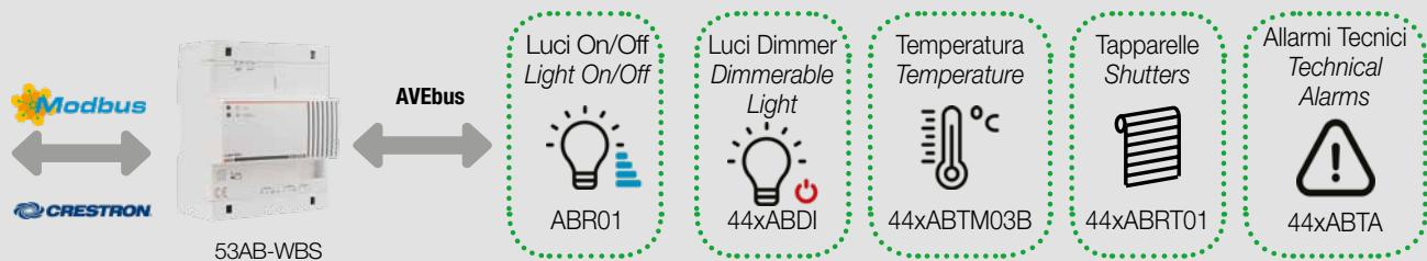
Il web server domotico 53AB-WBS permette di esporre il funzionamento dei dispositivi all'interno di registri Modbus, permettendone così il controllo e la gestione in modalità "slave" da un qualsiasi sistema BMS/SCADA compatibile con lo standard.
