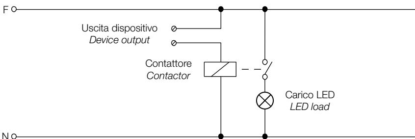
Nota: Se si utilizzano lampade LED è necessario interporre un teleruttore idoneo tra l'uscita del dispositivo ed il carico.
