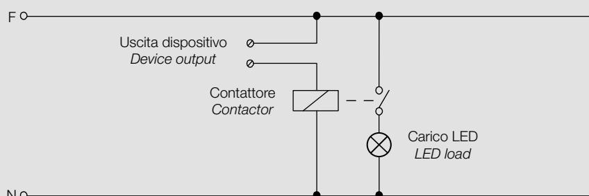
nota: Se si utilizzano lampade LED è necessario interporre un telerutture idoneo tra l'uscita del dispositivo ed il carico.
