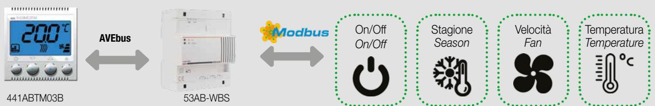
La gamma di supervisori dialoga con i principali marchi di Climatizzazione centralizzata, sfruttando il protocollo standard Modbus.
