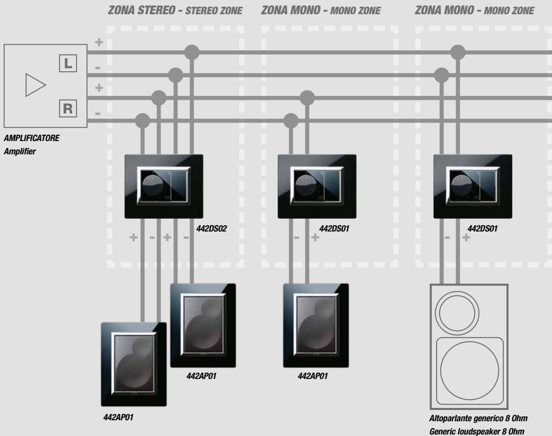
Il sistema consente la regolazione di zone stereo e mono e può essere utilizzato oltre che con gli altoparlanti Ave (442AP01 e 441AP01) anche con altoparlanti con impedenza 8 Ohm reperibili sul mercato.
