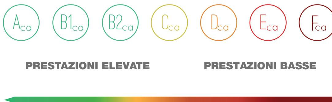
**Fig. 1 – Classi di reazione al fuoco definite dalla Norma UNI EN 13501-6**
