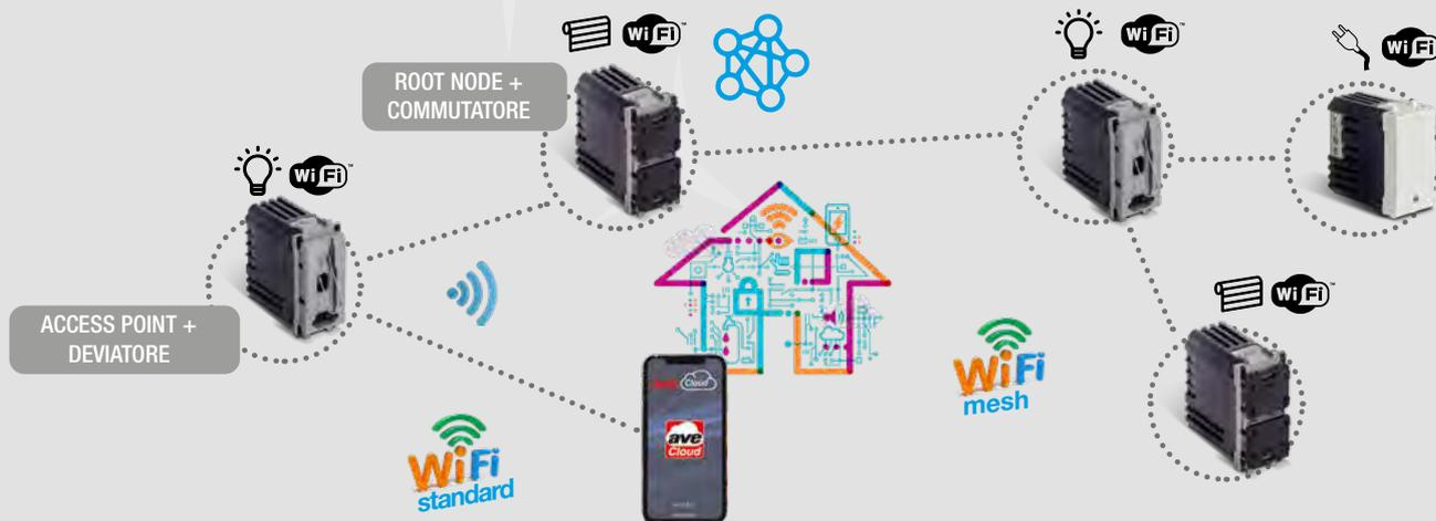
Modalità ROUTER DOMESTICO. Un dispositivo a scelta all’interno dell’impianto viene identificato come Root-Node. Connettendosi alla rete Wi-Fi® (generata dal router domestico) consente la supervisione, sia locale che remota, mediante l’applicazione AVE Cloud ed i più comuni Assistenti Vocali connessi al cloud.
