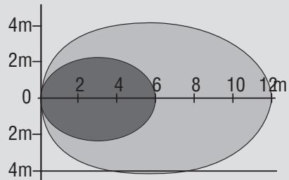
Diagramma sensore PIR – Vista laterale
