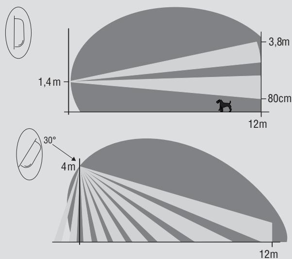
Nota: Prediligere installazioni dove ci sia un muro / pavimento a delimitare il campo di rilevazione del sensore. Se il sensore è puntato nel vuoto la distanza di copertura si riduce a 8m. Dove non sia possibile una installazione parete/parete o soffitto/pavimento prediligere l'installazione a sensore inclinato.
