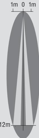
Vista laterale con parzializzatore lente - Side view with blinding lens
