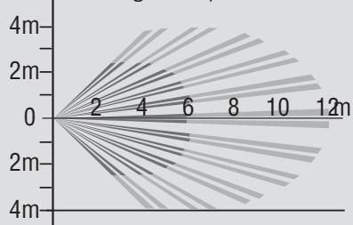
Diagramma sensore MW – Vista dall'alto
