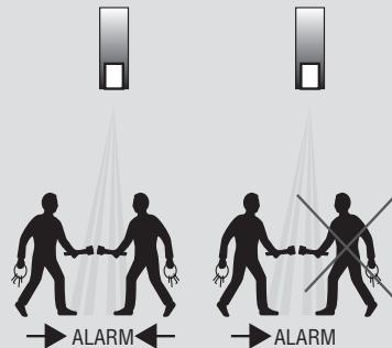
Nota: L'allarme avviene attraversando entrambe le barriere create dai sensori PIR, oppure prima quella esterna, poi quella interna (non il contrario).
