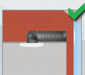
breve tratto di canalizzazione con singola curva short ducting with single curve
