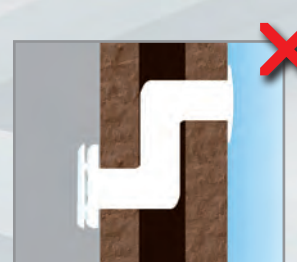
breve/lungo tratto di canalizzazione con più curve sconsigliato - short/long ducting with more curves is not recommended
