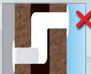
breve/lungo tratto di canalizzazione con più curve sconsigliato short/long ducting with more curves is not recommended
