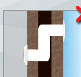
breve/lungo tratto di canalizzazione con più curve sconsigliato - short/long ducting with more curves is not recommended
